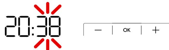
☞ Wird der veränderte Wert nicht innerhalb von 5 Sekunden mit OK bestätigt, beendet die Steuerung automatisch die Eingabe und der bisherige Wert bleibt erhalten.
